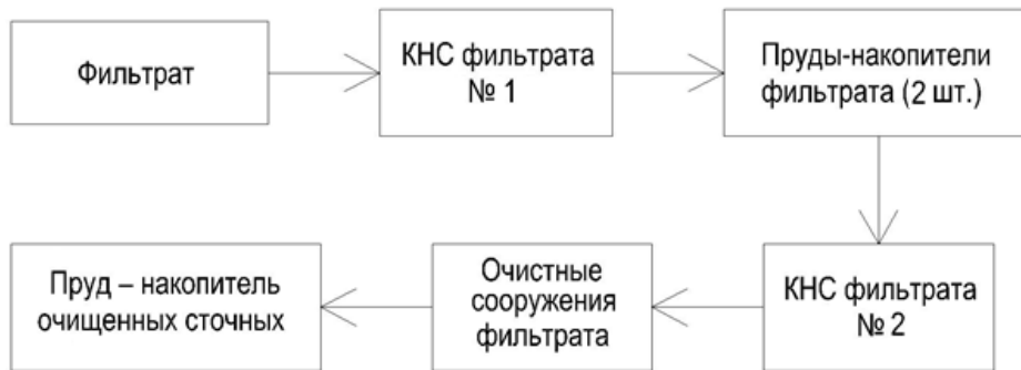
Рисунок 9. Принципиальная схема проектируемой системы удаления фильтрата
