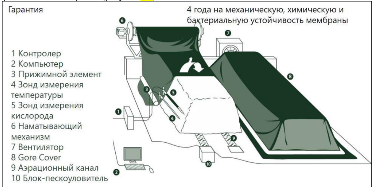
Рисунок 4.1 – Схема участка компостирования
