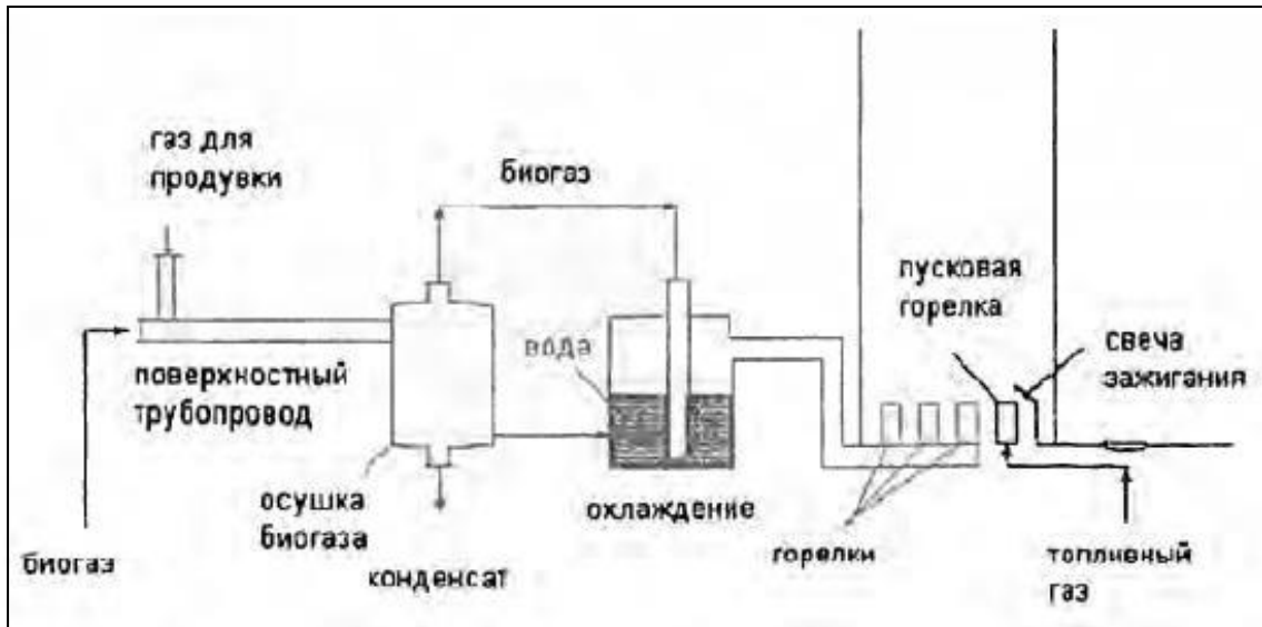
Рисунок 4.7 – Схема технологического процесса закрытого сжигания биогаза
