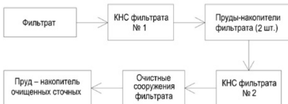
Рис.3 - Принципиальная схема проектируемой системы удаления фильтрата.
